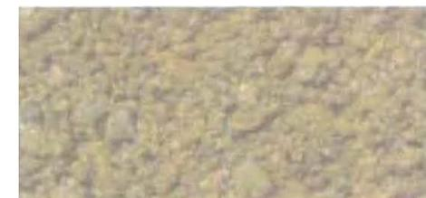
Sable identifié à partir d'un mortier de chaux. Présence d'argile.
