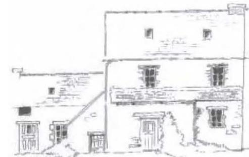
Pour la restauration de ces maisons, les précautions à prendre se situent au niveau de la couverture de l'avancée. Celle-ci doit être parfaitement réalisée pour éviter les infiltrations d'eau dans les murs.
